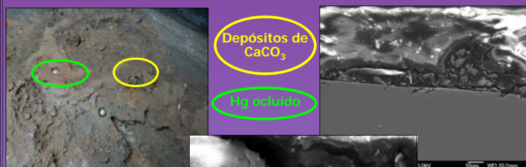
Figura 3. Macrografía del fondo del Bidón de 10 años. Detalle de los depósitos de CaCO 3
